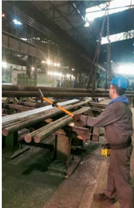
V SIJ Metalu Ravne uvajajo orodje 'hands off', s čimer zaposlenemu ni treba ročno upravljati in odlagati bremen. Tako bodo poskušali zmanjšati poškodbe rok oziroma prstov.
