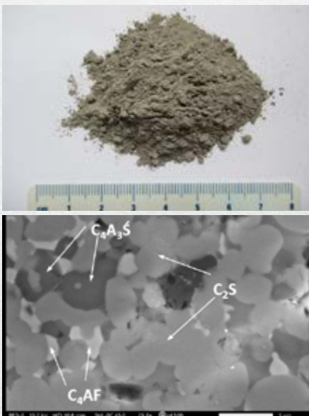
Surovinska moka (zgoraj) ter slika klinkerja BCSA pod elektronskim mikroskopom (spodaj)
