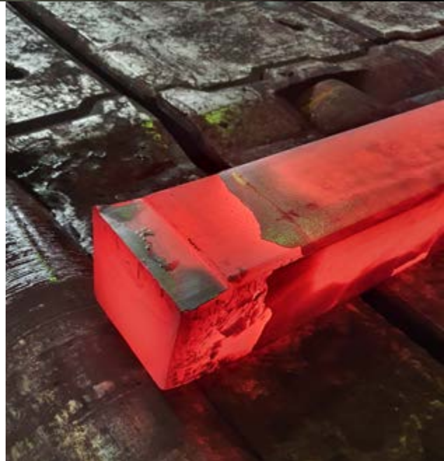
Lep in raven rez, brez večjih deformacij gredice
