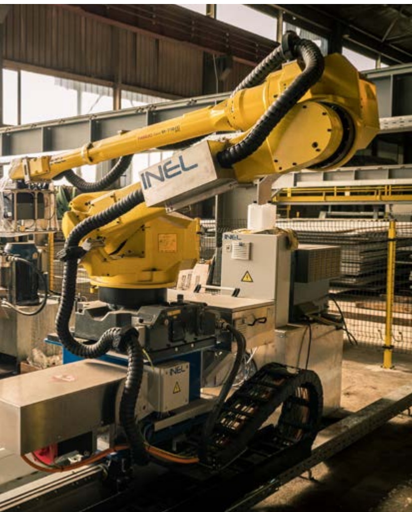
Naš novi sodelavec je robot za graviranje in signiranje plošč.
