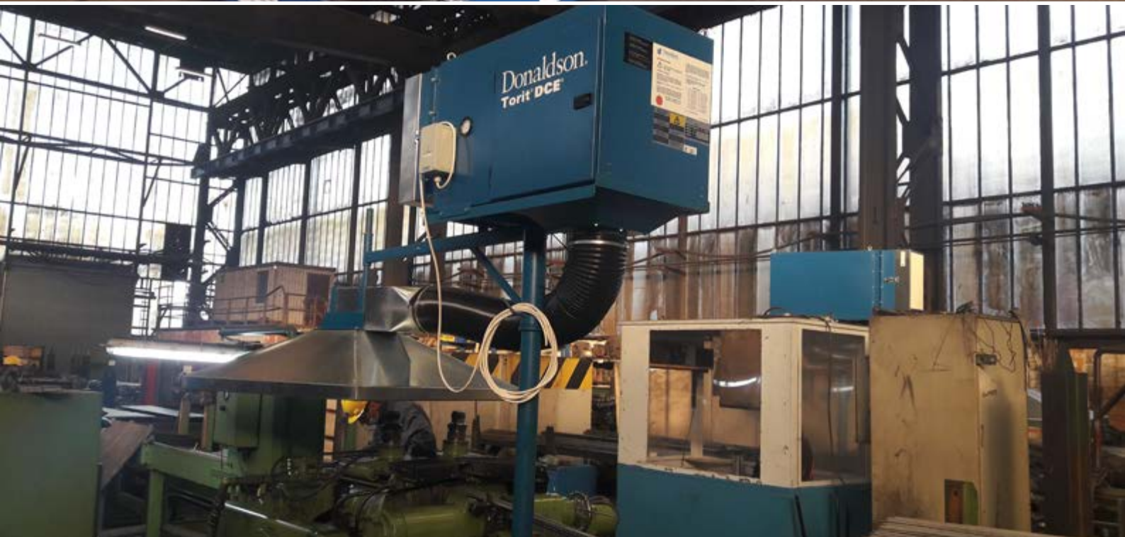
Odsesovalni sistem proti odsesava oljne hlapce, ki se sproščajo pri brušenju.
