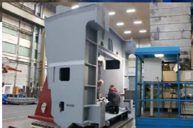
Ogromni zvarjenec na dodatni obdelavi pri zunanjem izvajalcu
