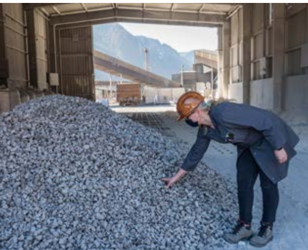
Sabina Trako, specialistka vhodne kontrole, izvaja vizualno kontrolo vhodnega materiala ferokrom (FeCr); v nadaljevanju se analiza izvaja v kemijskem laboratoriju.
