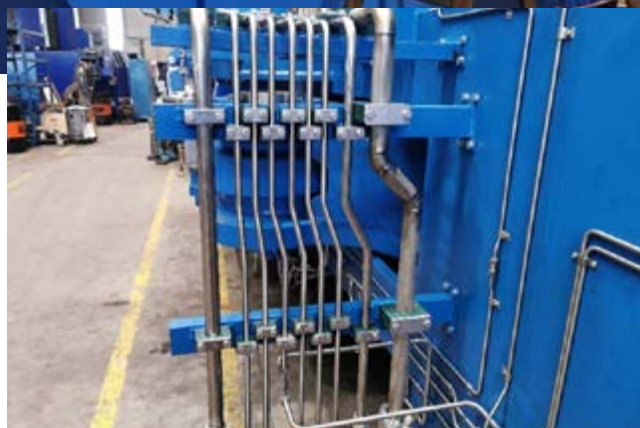
Škarje delujejo prek šestih cilindrov, ki jih poganja hidravlični agregat.
