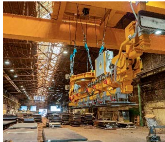
Mehansko vpetje s štirimi jeklenicami je ključno za hitro in natančno odlaganje plošč.
